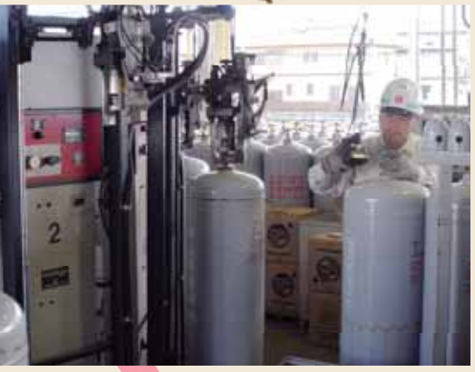
各家庭から集められた使用済み容器に職人技で次々と充てん。4分間に1回転する充てん機で一つ一つしっかり作業します。
