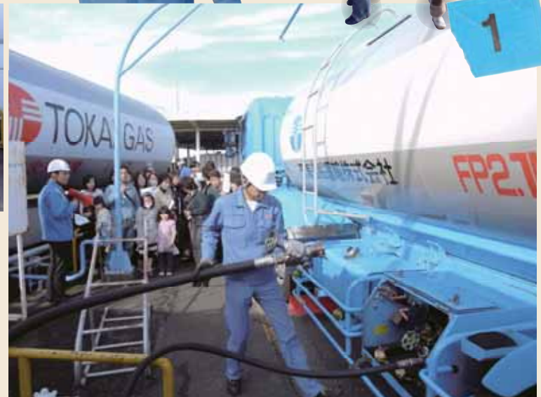
圧縮機（コンプレッサー）でストレージタンクからローリーに気体を押し込むことで、ローリー内の液化ガスがストレージタンクに移動します。細いホースは気体用、太いホースは液体用。
